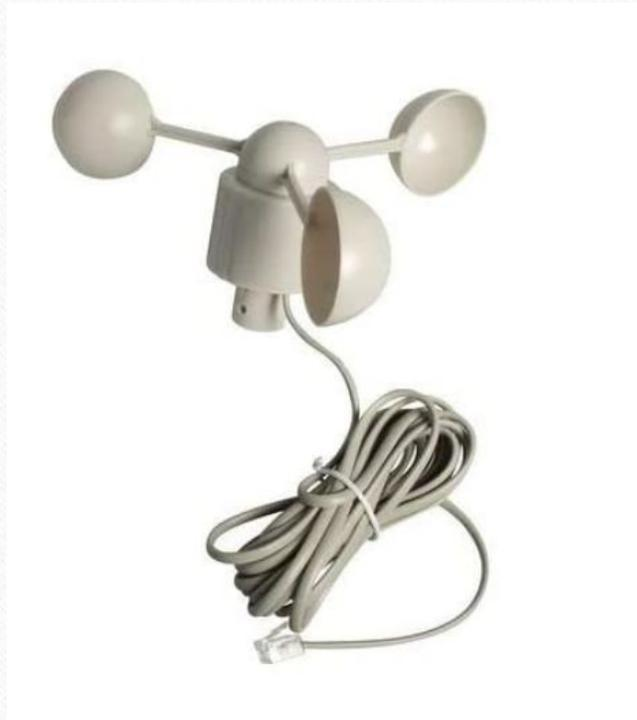
L'anemometro a coppa misura la velocità del vento chiudendo un contatto tramite un magnete che passa attraverso un sensore. L'unità di misura dell'anemometro è km/h.
